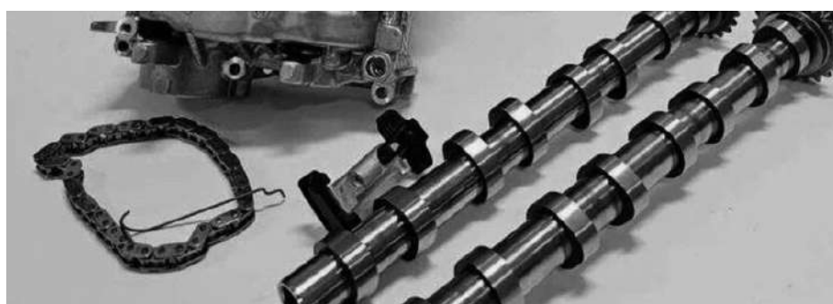
Stellantis PSA moteur 1.5 BLUEHDI rupture chaîne arbres à cames moteur HS
