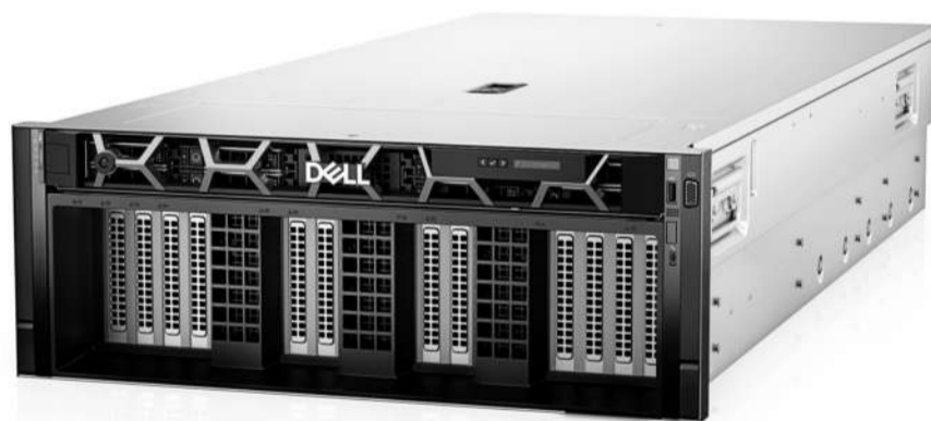
Le PowerEdge XE9680L va accueillir les GPU B200 de Nvidia et un système de refroidissement liquide
